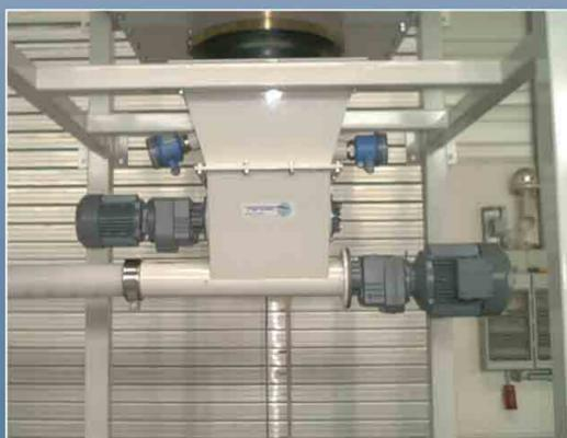
Länglicher Produktpufferbehälter Typ FW mit horizontalem Auflockerungsrührwerk
