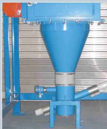
Konischer Produkt-aufnahmebehälter Typ RF für rieselfähige Schüttgüter zum Anflanschen eines Spiralförderers Typ FR
