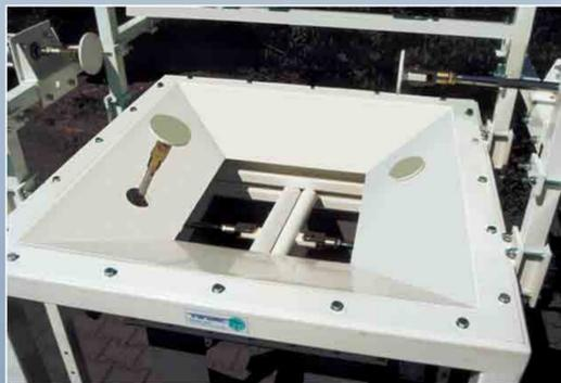
Bodenwahrung mittels Pneumatikzylinder als Austraghilfe zur Entleerung von Big-Bags mit brückenbildendem Inhalt
