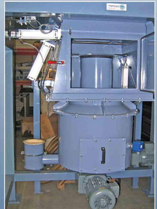
Zylindrischer Produktaufnahmebehälter mit Flachboden
