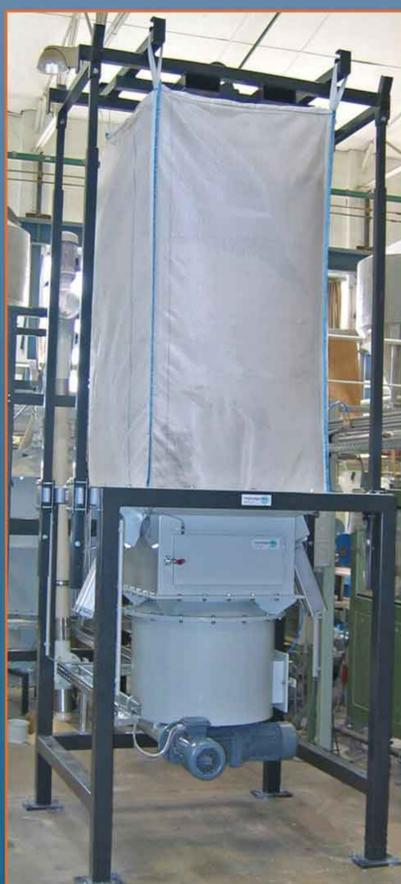
Big-Bag Entleerstation mit höhenverstellbarem Obergestell sowie automatischer Big-Bag Strafvorrichtung
