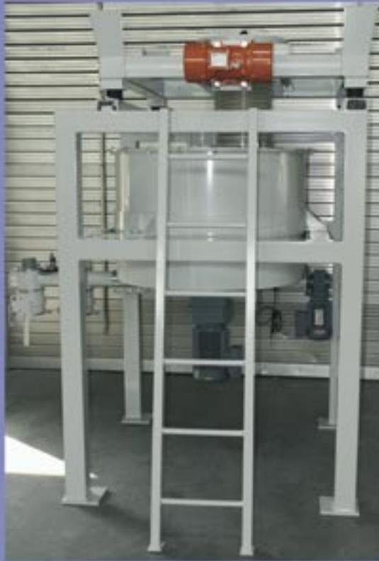
● Station vidange conteneurs pour produits pulvérulents de mauvais écoulement avec cadre vibrant
