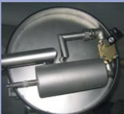
La conception de l'alimentateur pneumatique dépend du produit à convoyé, de la distance à parcourir ainsi que du débit demandé. Sa conception dépendra du volume de la trémie de séparation, du produit et du rendement de la turbine d'aspiration.
