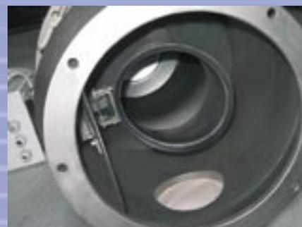
Nettoyage automatique du filtre après chaque processus d'aspiration par injection d'air comprimé en intervalles.
